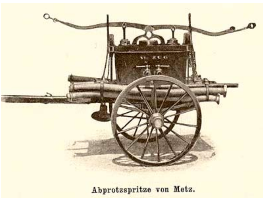
Na obrázku je ruční požární stříkačka umístěná na dvukolovém vozíku z roku 1867, vyrobená dle systému Metz. Ve své době byla považována za vysoce moderní zařízení k hašení požárů.
