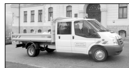
Naposledy pořídilo město pro potřeby technických služeb malý nákladní automobil FORD, sklápěč s dvoukabinou. Vozidlo slouží k přepravě odpadů, trávy, materiálu, malé mechanizace a zároveň pracovníků na práce.
